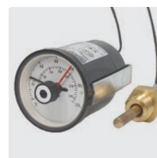
1/2" AG. Kontakt 5 A - 250 V (AC1). Temperaturanzeige 0 - 120 °C
